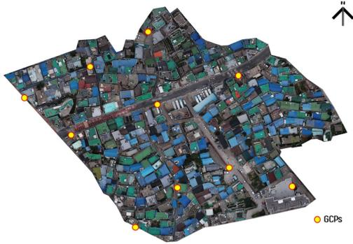
그림 4. R8s를 이용한 GCP 좌표 측량과 GCP의 위치
