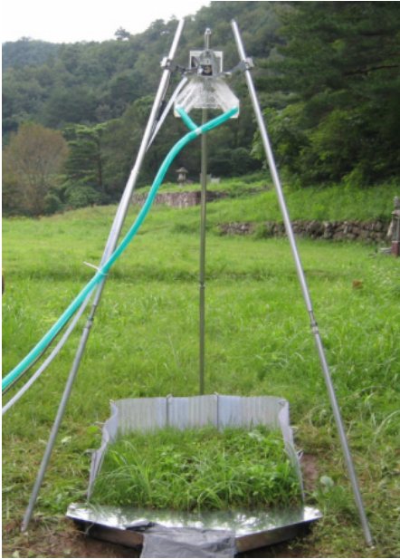
그림 1. 본 연구에서 사용된 인공 강우 시뮬레이터
